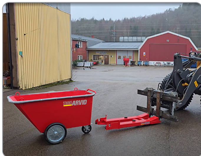
Affaldsvognstømmere kører ind under affaldsvognen for at løfte den op. Affaldsvognstømmere låser sig fast omkring hjulakslen på affaldsvognen.
