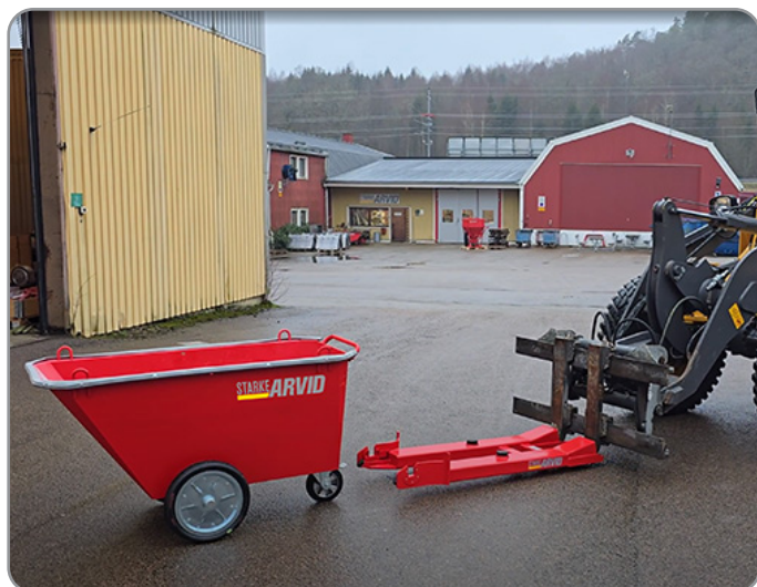
Avfallsvogntømmern kjører inn under avfallsvognen for å løfte den opp. Avfallsvogntømmern låser seg rundt hjulakslingen på avfallsvognen.
