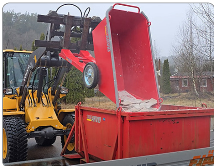
Enkel tömning av avfallet med hjälp av den smidiga tömningen av Fodervagnarna med Fodervagnstömmaren.
