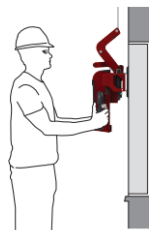
Pivot-armen frigörs manuellt och fönstret skjuts in på plats i fönsteröppningen.
