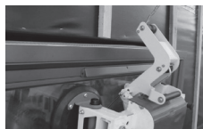
Pivotarmen deaktiveres idet vinduet skubbes på plads
